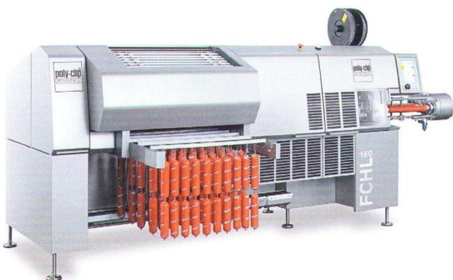
Der neue Clip-/Aufhänge-Automat FCHL 160 vereint vier Pro- duktionsprozesse in einer Maschine. Übernimmt der Automatic Sausage Loader ASL-R die Beladung der Rauchwagen, erhöht sich die Ausbringungsrate zusätzlich.
